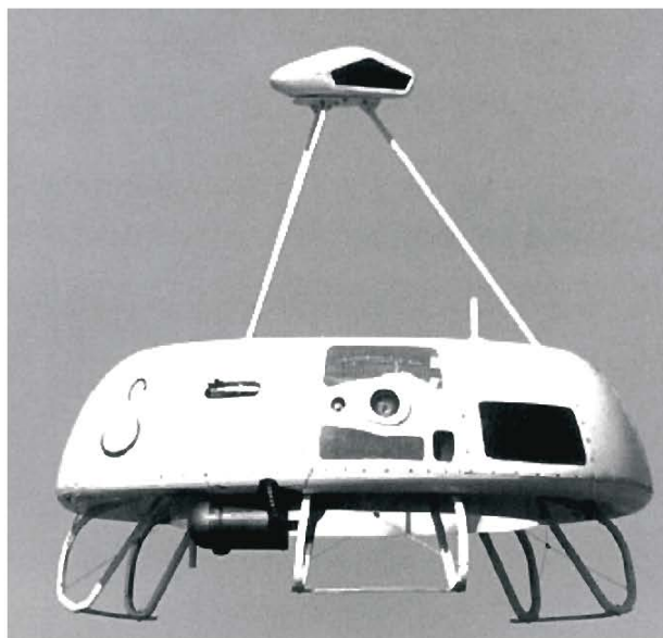
Figura nr. 7 - MAV Cypher folosește varianta celor două rotoare coaxiale intubate
