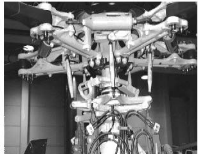
Figura nr. 2 - Rotorul portant de tip „articulat” al unui elicopter
