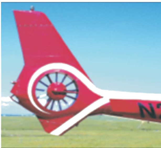
Figura nr. 3 - Model de elice anticuplu intubată
